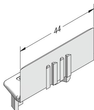
Внешний торцевой колпачок упорной планки шульпа SYNEGO®
